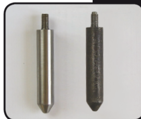
Korróziógátló adalék hatása MOL adalékkal ellátott és adalékoltan motorbenzin esetén
